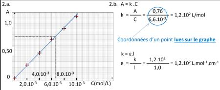
2.c. La solution utilisée pour réaliser le spectre d'absorption (courbe  $A=f(\lambda)$ ) a une concentration de 4,5.10<sup>-3</sup> mol/L donc pour la longueur d'onde étudiée, l'absorbance vaut:
